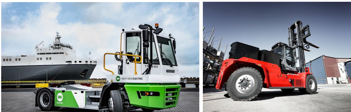
Figur 15. 1) Elektrisk terminaltraktor til venstre. Foto: Terberg 2) Elektrisk reachstacker. Foto Kalmar
